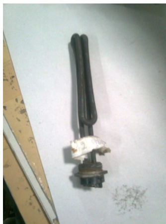
FIGURA 3.15. RESISTENCIA DE CALDERA DE VAPOR
