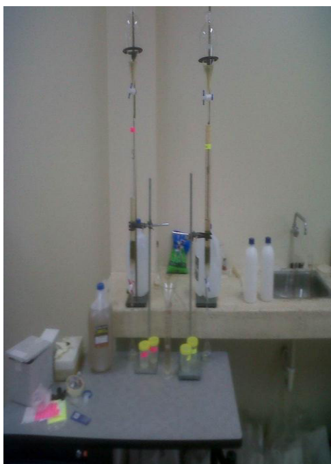
Figura 6.2: Adsorción de cationes en columnas y curva de ruptura de un adsorbente
