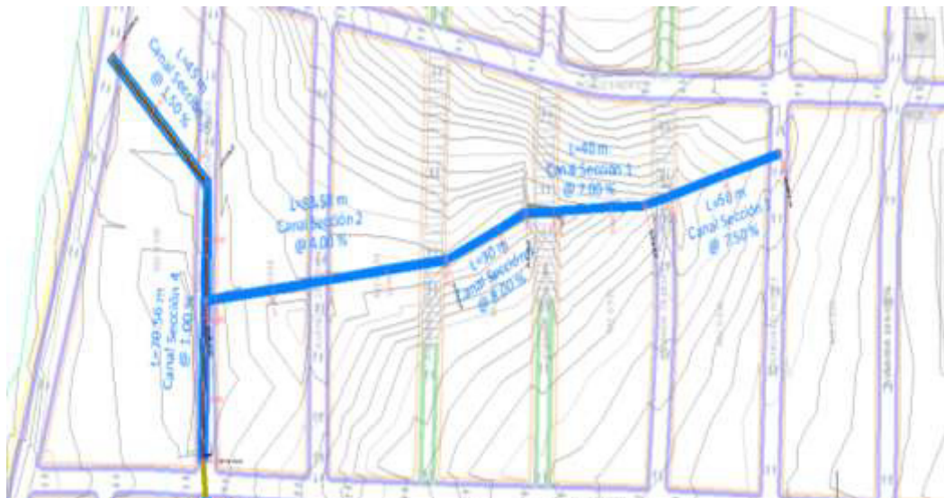
Ilustración 4.26 Alineamiento del sistema de drenaje que cruza en medio de viviendas
