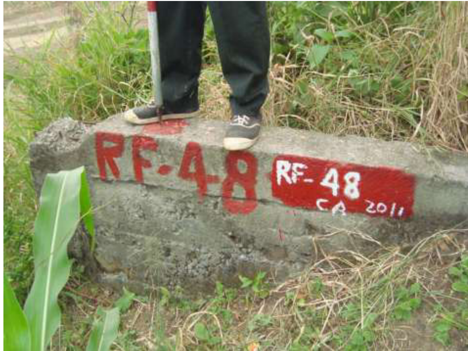
FOTO 3.1 Referencias físicas con marcas de pintura roja
