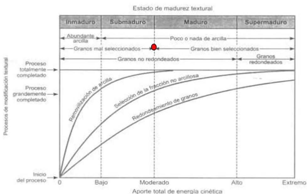
**Figura 3.17** Gráfico de madurez textural de una roca detrítica arenosa, según Pozo 2004. Los sedimentos de la Fm. Borbón se representan con el círculo rojo.
