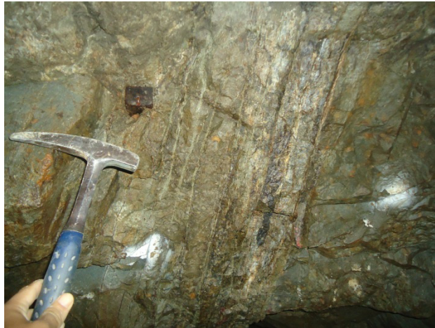
Fig. 15. Alteración centimétrica de la veta "Paraíso" en el Nv. 5. (Fuente: Autor)
