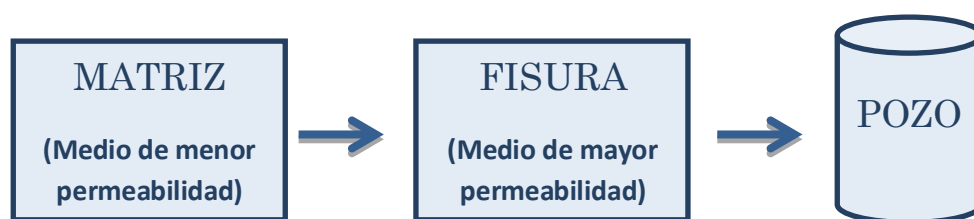
Fig.2.1—Flujo dirigido desde los bloques hacia la fractura
