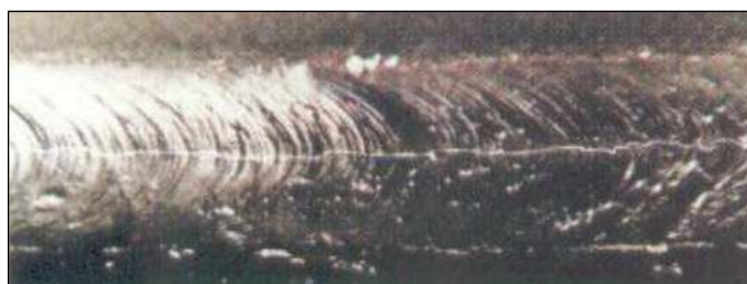
FIGURA 4.7.- FISURA DE GARGANTA Y DE RAÍZ
