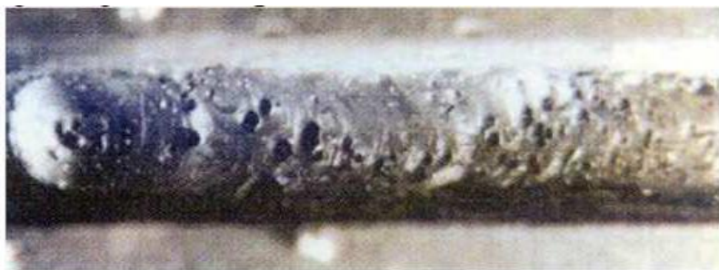
FIGURA 4.8- POROS DISTRIBUIDOS UNIFORMEMENTE
