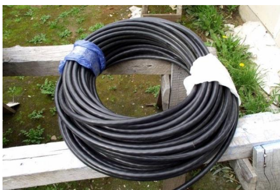
Figura 3.13. Cable 3x10 AWG Concéntrico
