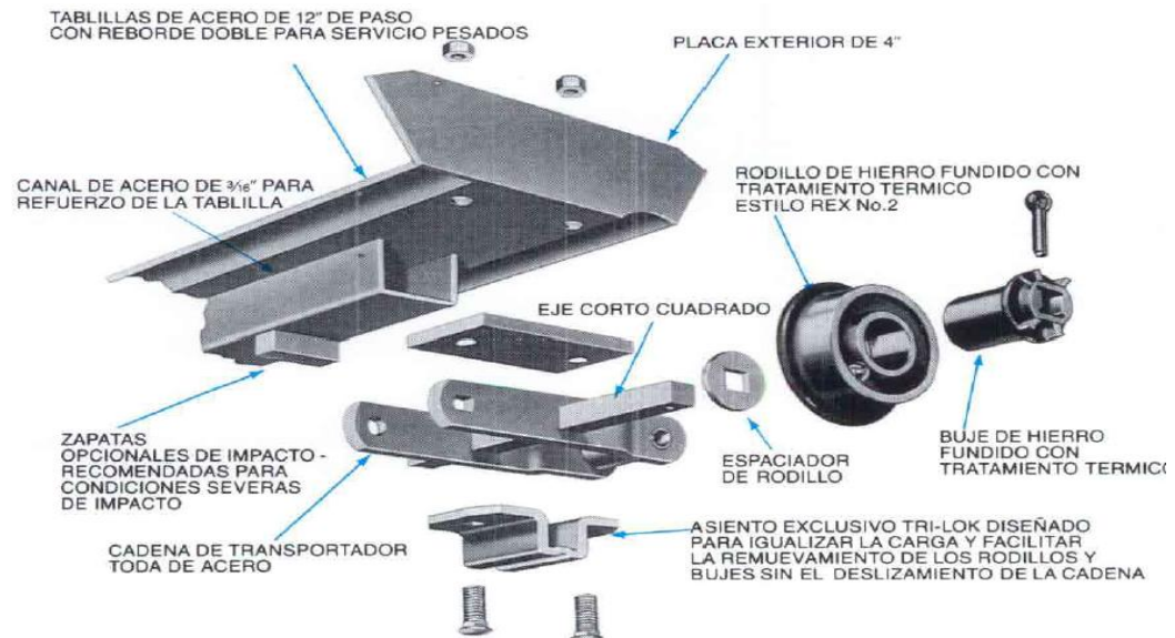
Figura 2.49 Esquema del ensamble del transportador de placas metálicas
