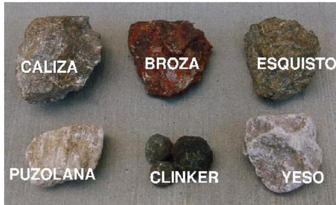
**Figura 1.3 Materias Primas para el procesamiento de Cemento**
