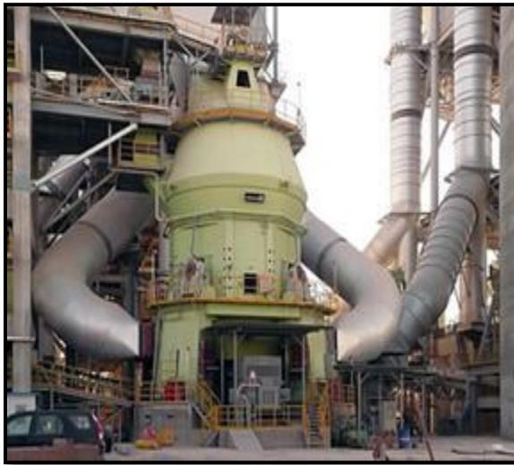
**Figura 1.14 Molienda de crudo mediante el Molino Vertical**
