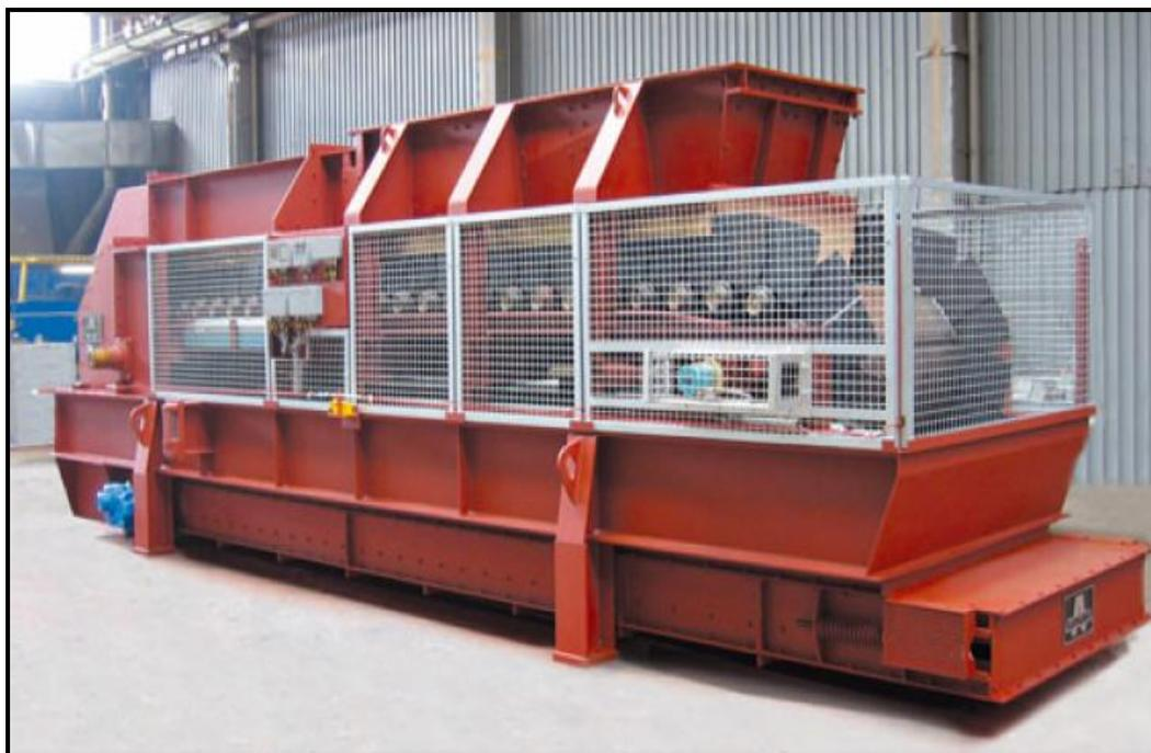
**Figura 2.41 Alimentador de Placas metálicas**
