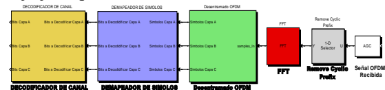
Figura 26 Diagrama de bloques en Simulink del modelo receptor ISDB-Tb
