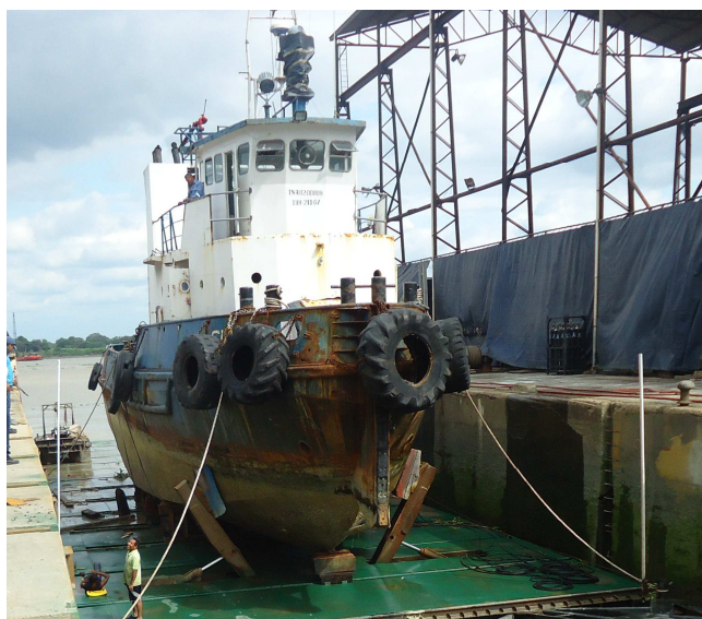
Figura N°34: Remolcador Sirius, varado utilizando los brazos hidráulicos de proa ya instalados.
