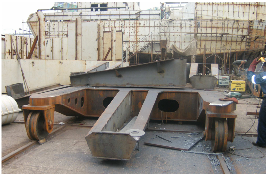
Figura N°21: Carros de Transferencia Nuevos y estructura cajón.
