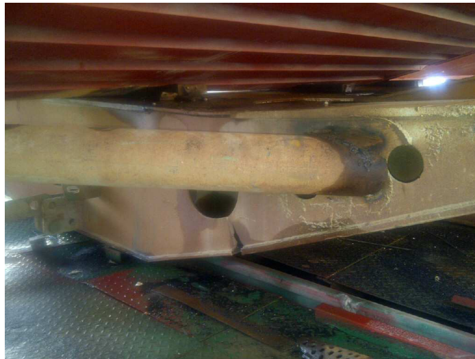
Figura N° 16: Daño en carro de transferencia nuevo.
