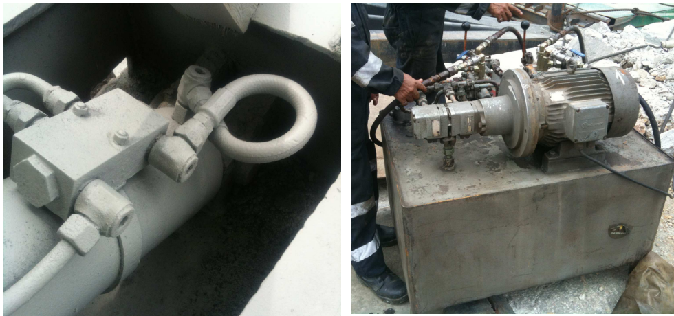
Figura N°24: Accesorios Hidráulicos (300 Bar).
