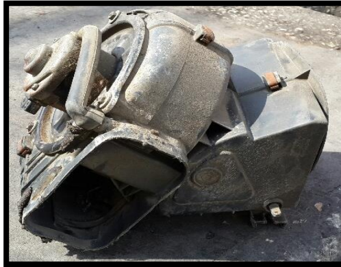
Fig. 5. EVAPORADOR Y ELECTROVENTILADOR DESMONTADO. FUENTE AUTOR.
