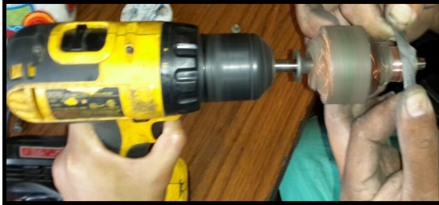
Fig. 11. MANTENIMIENTO DEL ROTOR. FUENTE AUTOR.
