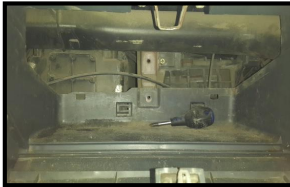
Fig. 4. DESMONTAJE DE LA CUBIERTA INTERNA DE LA SECRETA. FUENTE AUTOR.
