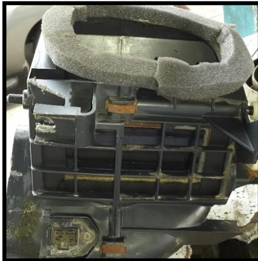
Fig. 16. ACOPLA DEL ELECTROVENTILADOR CON EL EVAPORADOR. FUENTE AUTOR.
