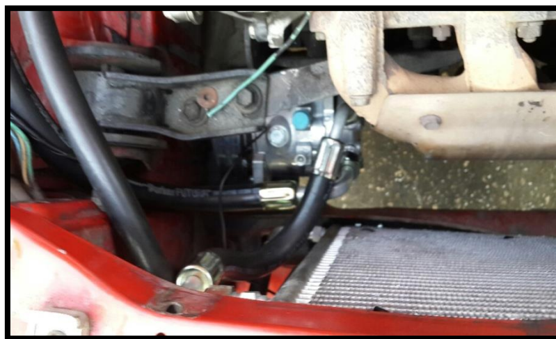
Fig. 20. MONTAJE DEL COMPRESOR Y MANGUERAS I, II, III. FUENTE AUTOR.
