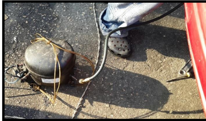
Fig. 24. APLICACIÓN DE LA BOMBA DE VACIO. FUENTE AUTOR
