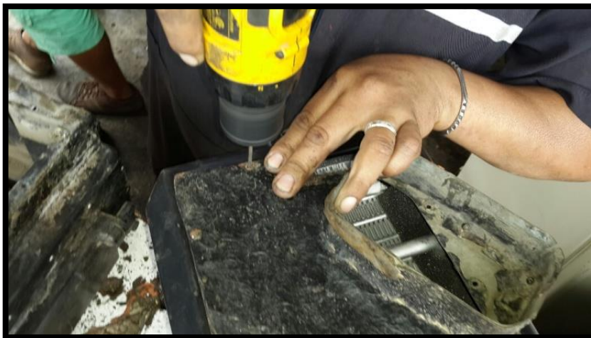
Fig. 14. MONTAJE DE TAPAS AL EVAPORADOR. FUENTE AUTOR.
