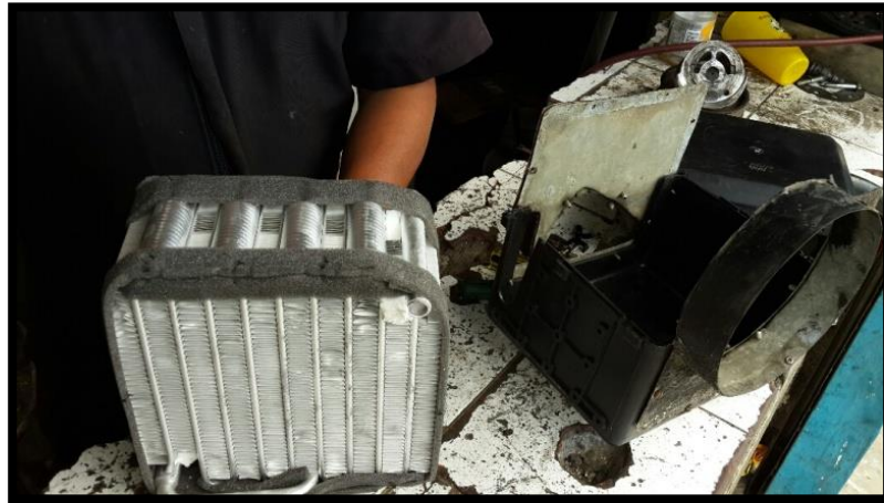
Fig. 13. MONTAJE DEL EVAPORADOR A LA CARCAZA. FUENTE AUTOR.
