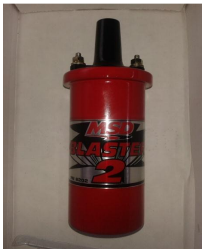
Figura 4-2: Bobina de Alto Desempeño (MSD BLASTER 2).
