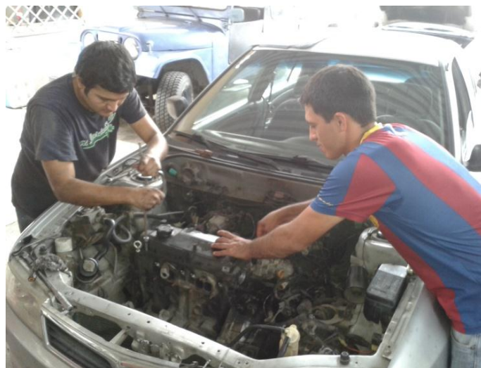
Figura 1-3: Desmontaje del Motor.
