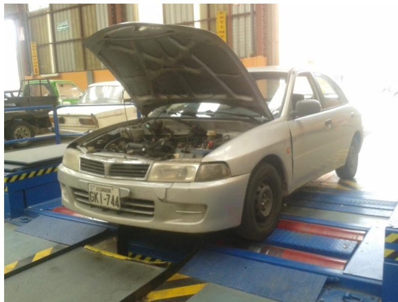
Figura 1-14: Prueba en el Dinamómetro.
