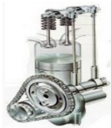
Figura 2-8: Sistema de Distribución.
