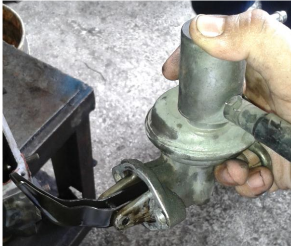
Figura 2-28: Bomba de Combustible Mecánica.
