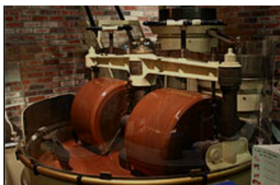
FIGURA 1.19 OBTENCIÓN DE LICOR DE CACAO
