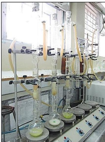
**Figura 2.1.** Sistema Soxhlet
