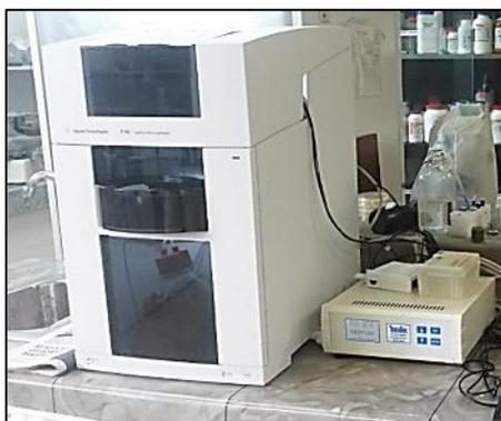
**Figura 2.2.** Equipo de electroforesis capilar
