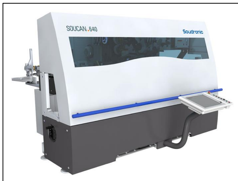
FIGURA 2.3. FORMADORA DE CUERPO SOUCAN 640 (7).
