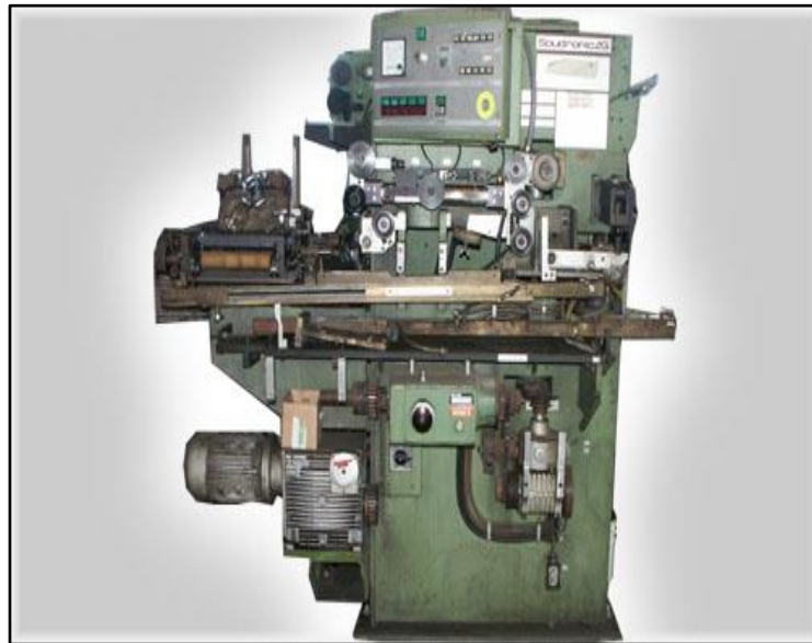
FIGURA 1.5. FORMADORA DE CUERPO CASTOR VAAK 50
