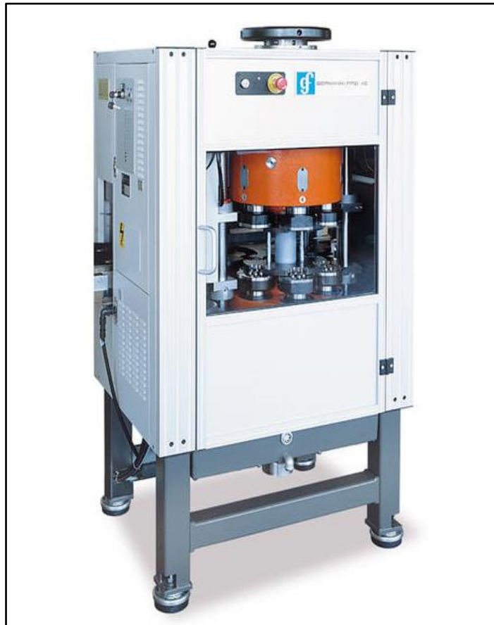
FIGURA 2.8. PESTAÑADORA POR RULINAS GERMANN FREI SFV 600.
