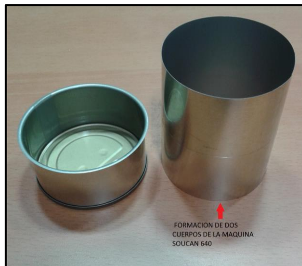
FIGURA 2.4. FORMADO DE CUERPO DOBLE SIN SEPARAR.
