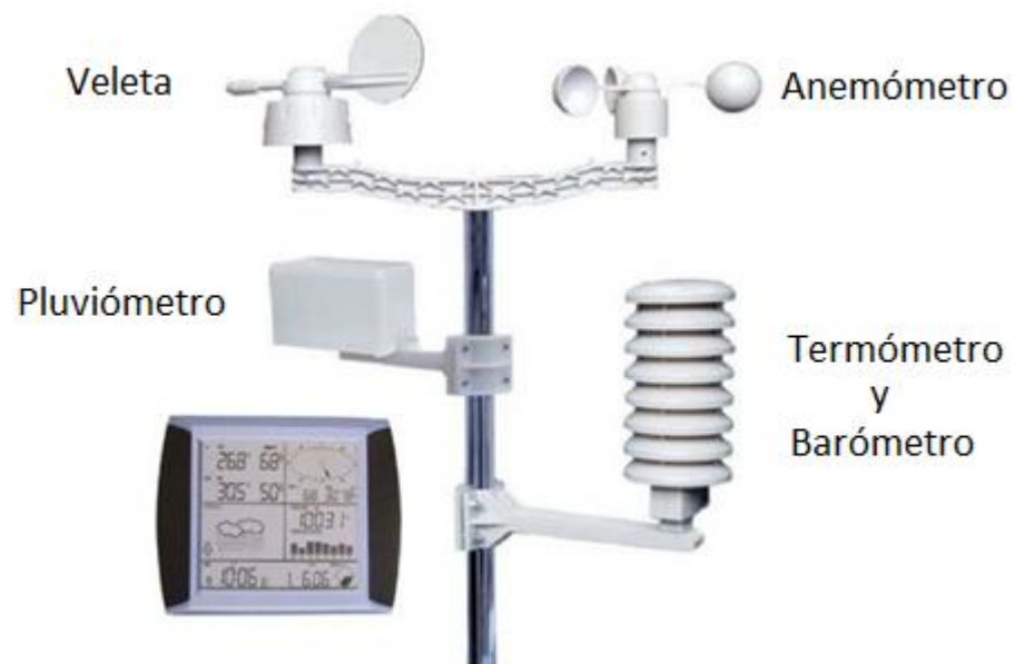
Figura 3.1 Sensores Típicos de una estación meteorológica
