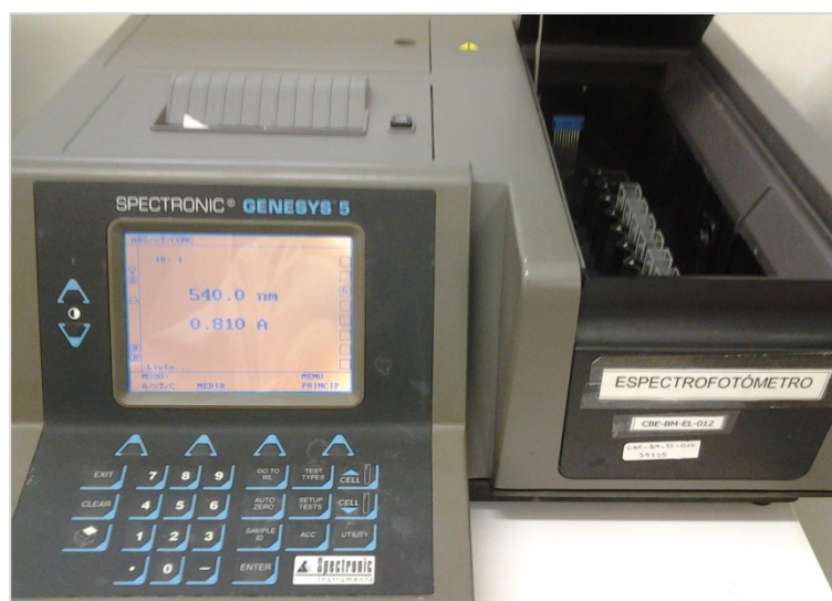
FIGURA 2.8 Espectrofotómetro para medir la absorbancia
