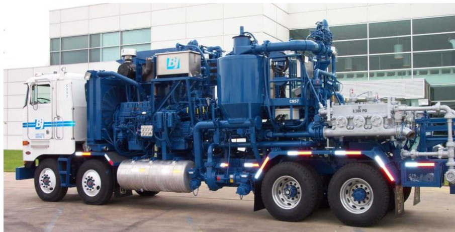
Figura 10: Unidad de cementación on-shore
