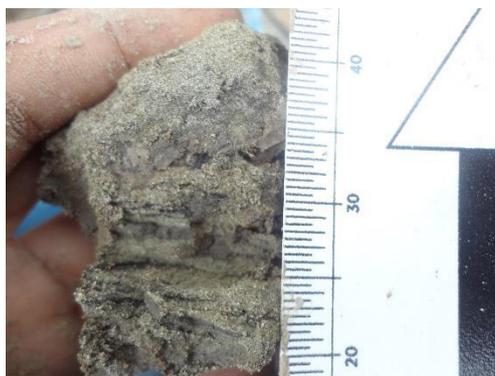
**Figura 4.45.** Limo con intercapas de arena y lignito.
