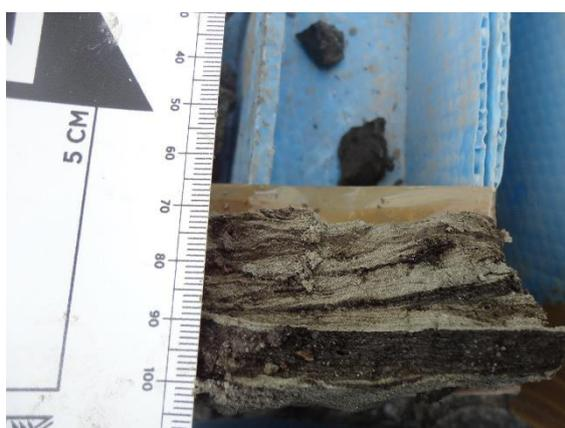
**Figura 4.66.** Limo con intercapas de lignito.
