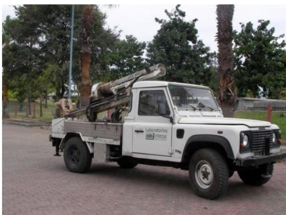
**Figura 3.1.** Sonda TP 50 sobre Land Rover.
