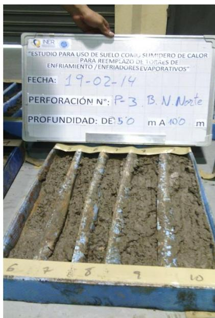
**Figura 3.3.** Caja plástica para conservar la humedad de testigos recuperados.
