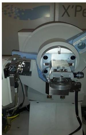
**Figura 3.10.** Difractómetro de Rayos X.
