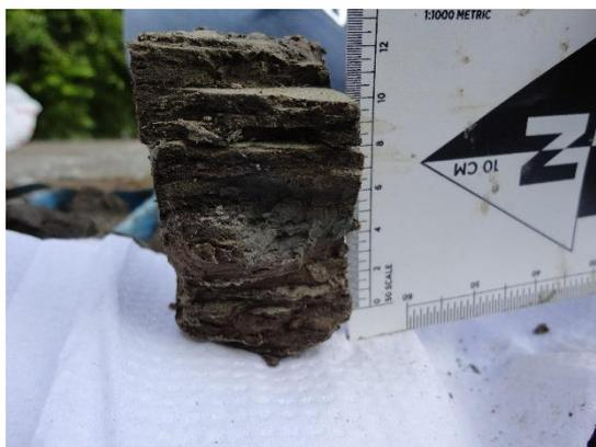
**Figura 4.38.** Limo con intercapas de arena y lignito.
