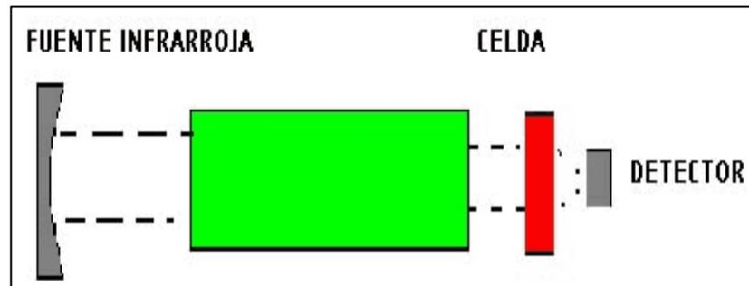
**Figura 1.11. Esquema sensores infrarrojos (8)**
