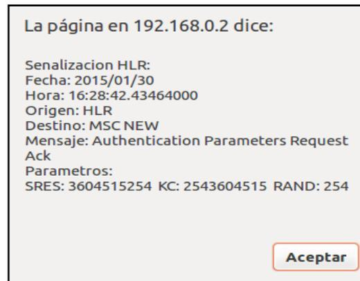
Figura 20. Mensaje Authentication Parameters Request Ack.
