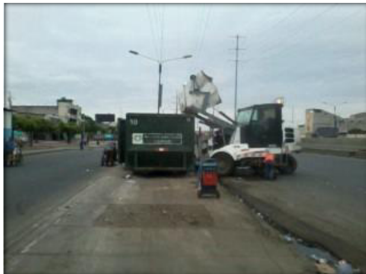
Foto 13: Barredora Mecánica descargando al contenedor los materiales inertes
