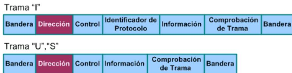
**Figura 4.5 Campo de Direcciones en AX.25.**
