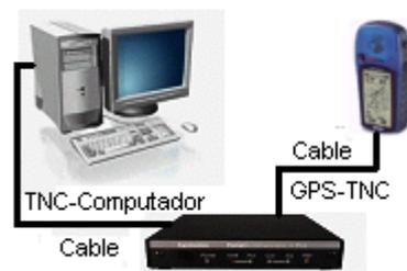
**Figura 8.1 Elementos de Prueba Comunicación entre GPS-TNC**
