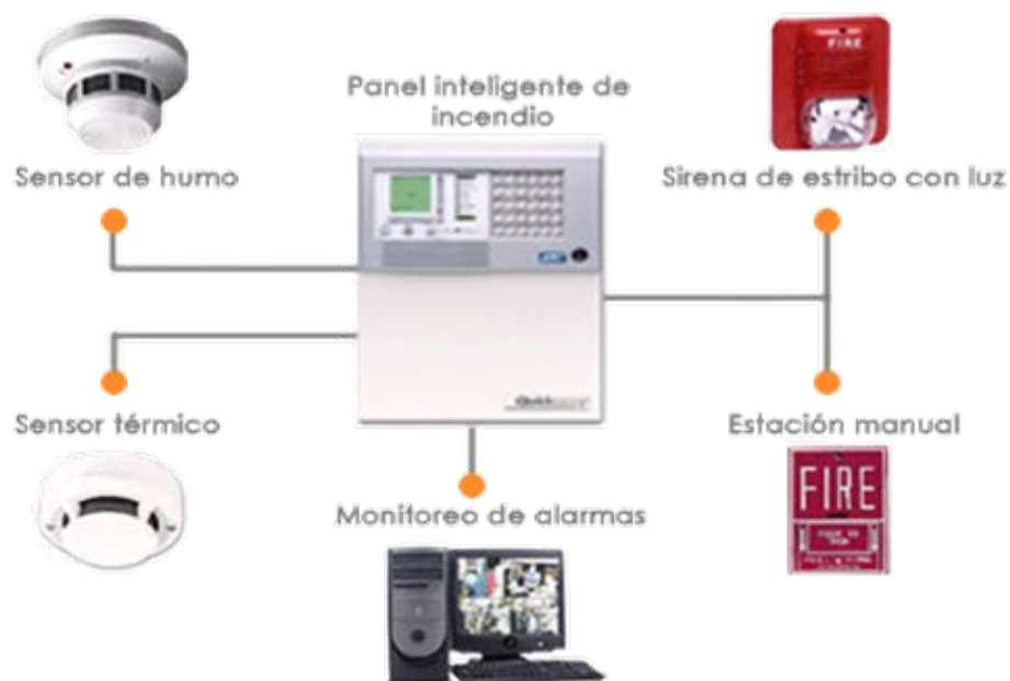
Figura 3.6 Sistema de Detección y Extinción de Incendios
