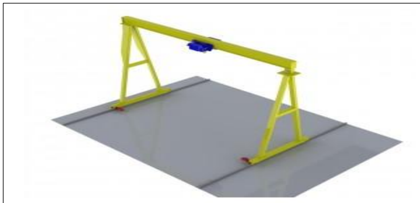
Figura 2.15 Grúa pórtico con dos columnas, monorriel. [10]
