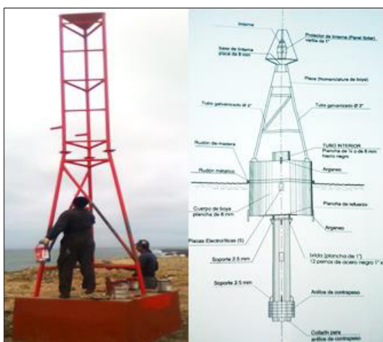
FIGURA 2.3 PARTES DEL SISTEMA ESTRUCTURAL
