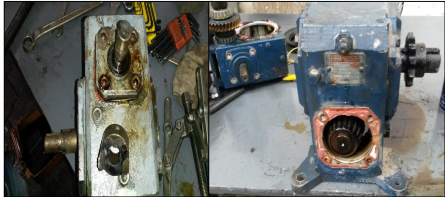
Figura 3.4. Limpieza de las cajas reductoras
