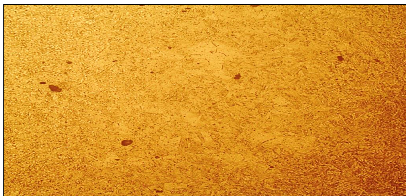
Figura 5.20. Microestructura de la sección transversal en el centro (200x)
