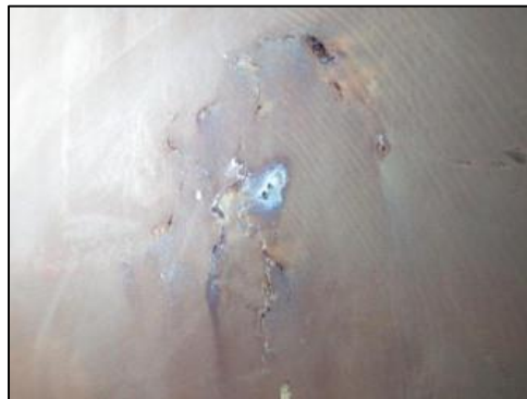
Figura 1.6. SCC en Tanque de Acero Inoxidable AISI 304
