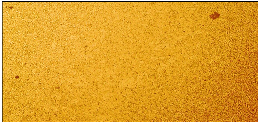
Figura 5.16. Microestructura de la sección transversal en el centro (200x)
