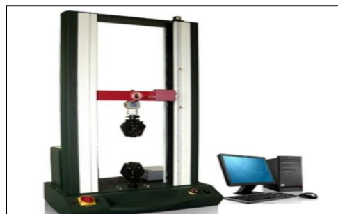
Figura 3.27. Máquina Elaborada en China para el Ensayo a Velocidad de Deformación Lenta
