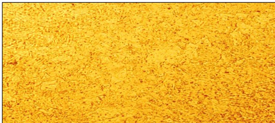
Figura 5.17. Microestructura de la sección transversal en el centro (500x)
