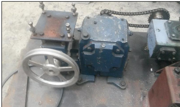
Figura 3.5. Conexión de las Cajas Reductoras por Medio de una Trasmisión por Cadena
