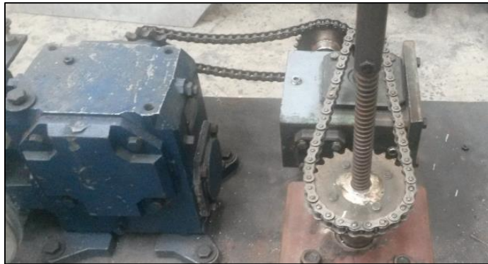
Figura 3.7. Conexión de las cajas reductoras a través de transmisiones por cadena
