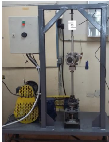
Figura 1: Banco experimental a velocidad deformación lenta para someter un material a corrosión bajo esfuerzos
