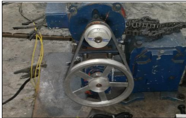
Figura 3.3. Instalación de Banda sobre las Poleas
