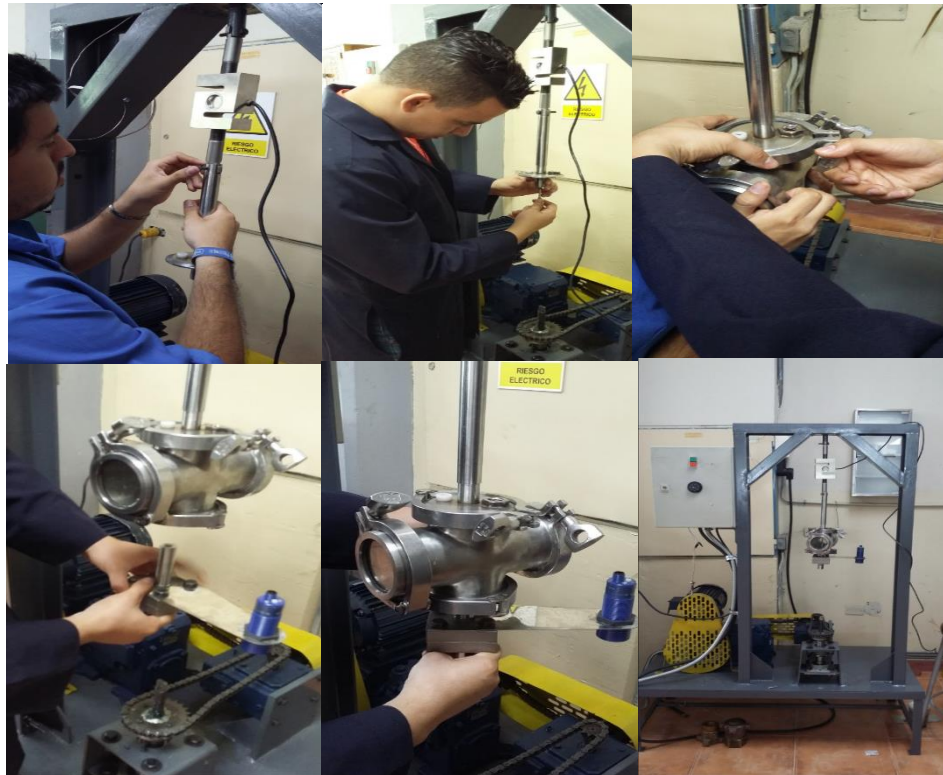
Figura 4.9. Proceso de ensamblaje de la parte superior de la probeta con la celda de carga
