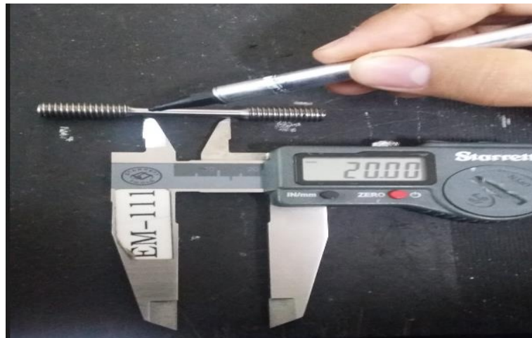
Figura 4.7. Marcación de la longitud Calibrada
