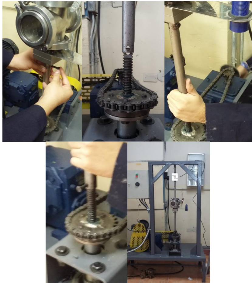
Figura 4.10. Proceso de ensamblaje del tornillo de potencia con la parte inferior de la probeta
