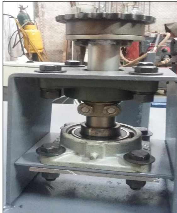
Figura 3.9. Instalación de las Chumaceras en el Soporte de Acero ASTM A36
