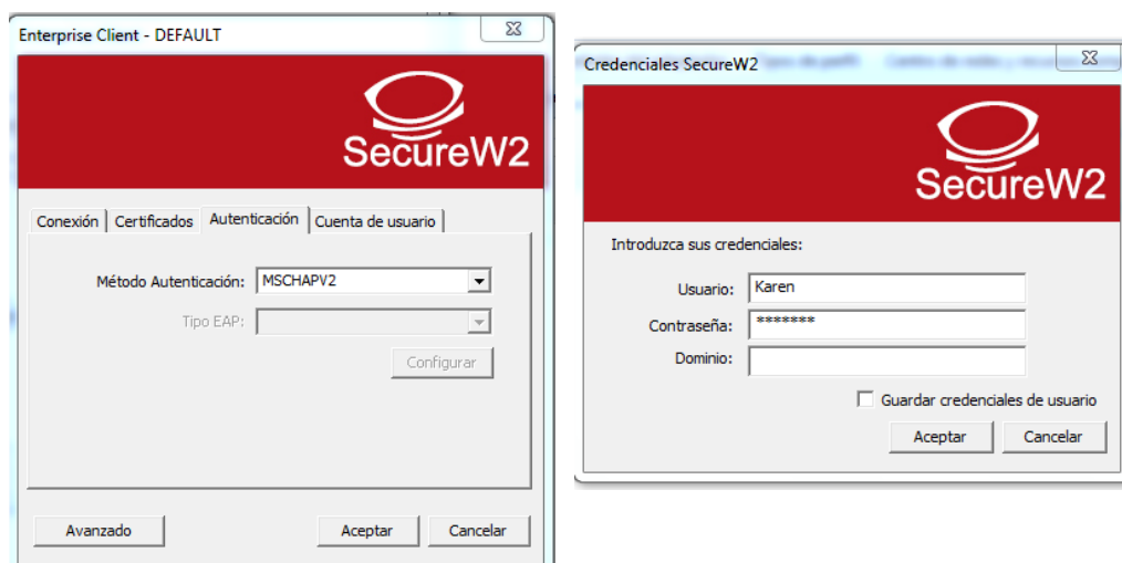
Figura 4.58 - Software suplicante de autenticación: configurado para MSCHAPv2
