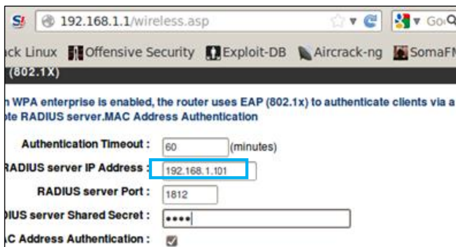
Figura 4.47 - Configuración de un ruteador como servidor RADIUS
