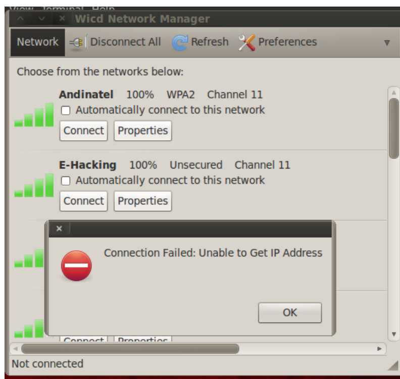
Figura 4.9 - Conexión a red protegida con filtrado MAC
