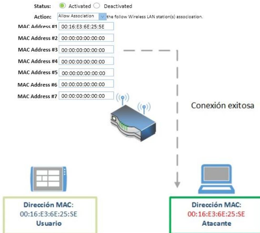
Figura 4.12 - Diagrama de red: Intervención de intruso mediante dirección MAC
