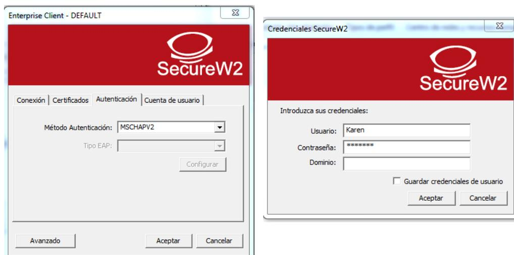
**Figura 4.58 - Software suplicante de autenticación: configurado para MSCHAPv2**
