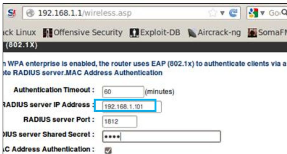
Figura 4.47 - Configuración de un router como servidor RADIUS
