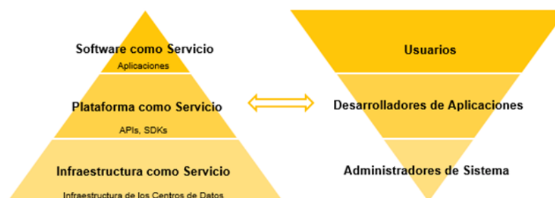
Figura 2.1 Modelo de servicios de Cloud Computing junto al cliente objetivo por nivel [8]
