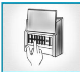
Figura 134. Desconexión del interruptor general.
