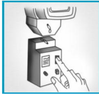
Figura 140. Desconexión del interruptor general antes de trabajar.
