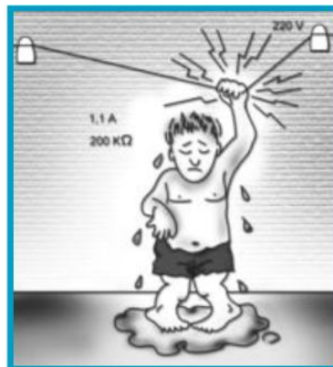
Figura 120. Mal aislamiento respecto al suelo (piel mojada).
