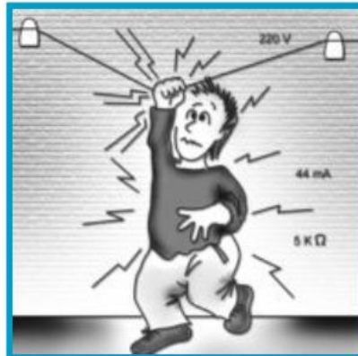
Figura 119. Aislamiento medio respecto al suelo.
