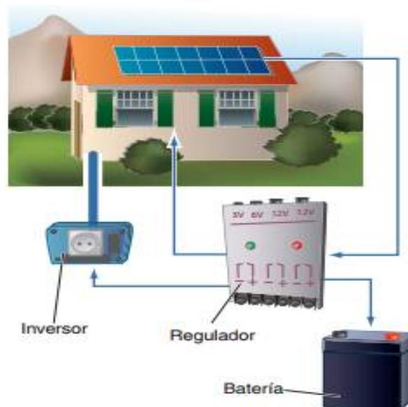
FIG. 2.1 SISTEMA FOTOVOLTAICO CON ACUMULADORES (BATERÍAS). FUENTE: [3].
