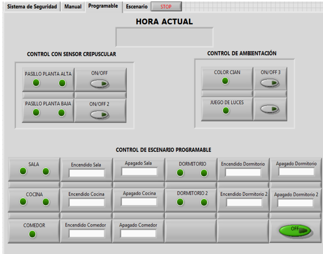
Fig. 5.12 Control programable del sistema de iluminación
