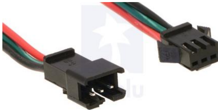
Fig. 6.35 Imagen de los conectores de la tira de LEDS
