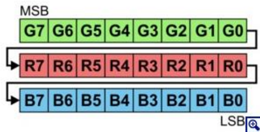
Fig. 6.33 Trama de datos de los LEDs
