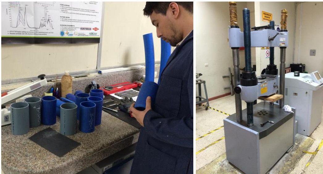
Figura 58. Ensayo de Rigidez anular. (Izq.) Preparación de muestras, (der) Maquina de ensayo Universal utilizada para la prueba
