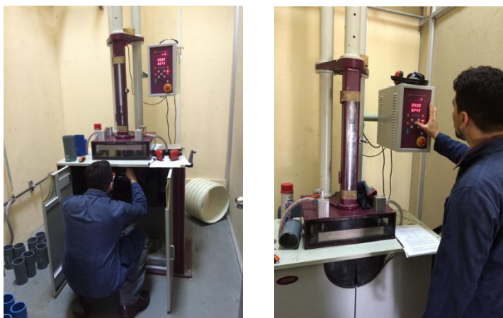
Figura 51. Prueba de impacto. (Izq) Colocación de probeta, (Der) Selección altura de impacto
