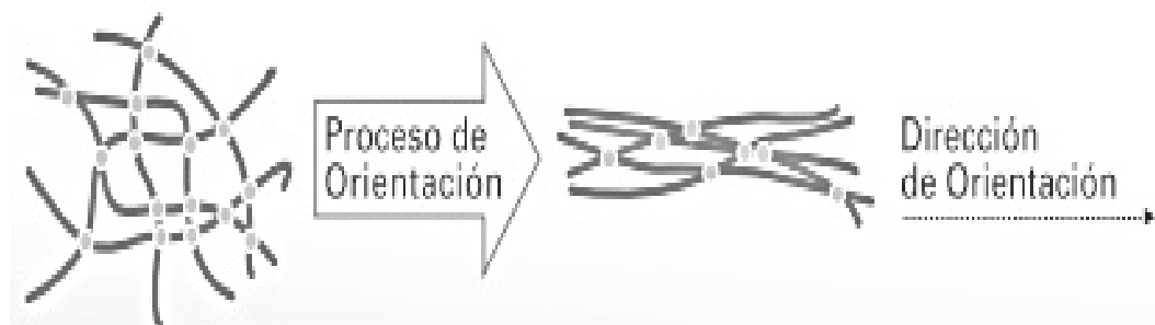
Figura 13. Efecto de la orientación estructural polimérica.
