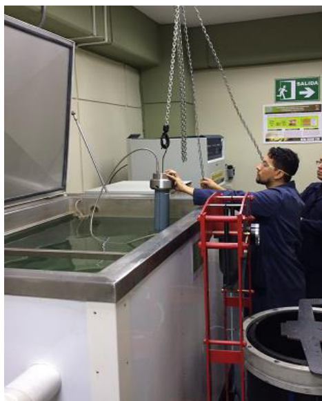
Figura 54. Prueba de Presión hidrostática. Introducción de probeta a cámara de presión
