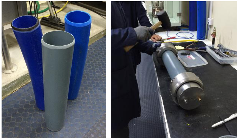
Figura 53. Prueba de presión hidrostática. Preparación de probeta
