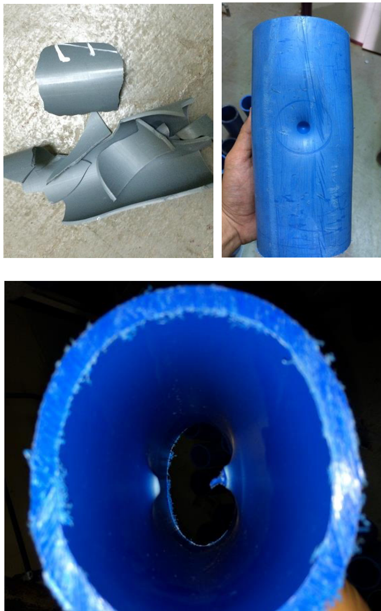
Figura 52. Afectación de las tuberías durante pruebas de impacto. Superior izq. PVC, Superior der. PE100, Inferior PE100-RC
