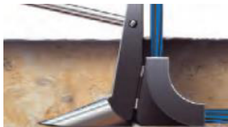
Figura 46. Ilustración de método de arado
