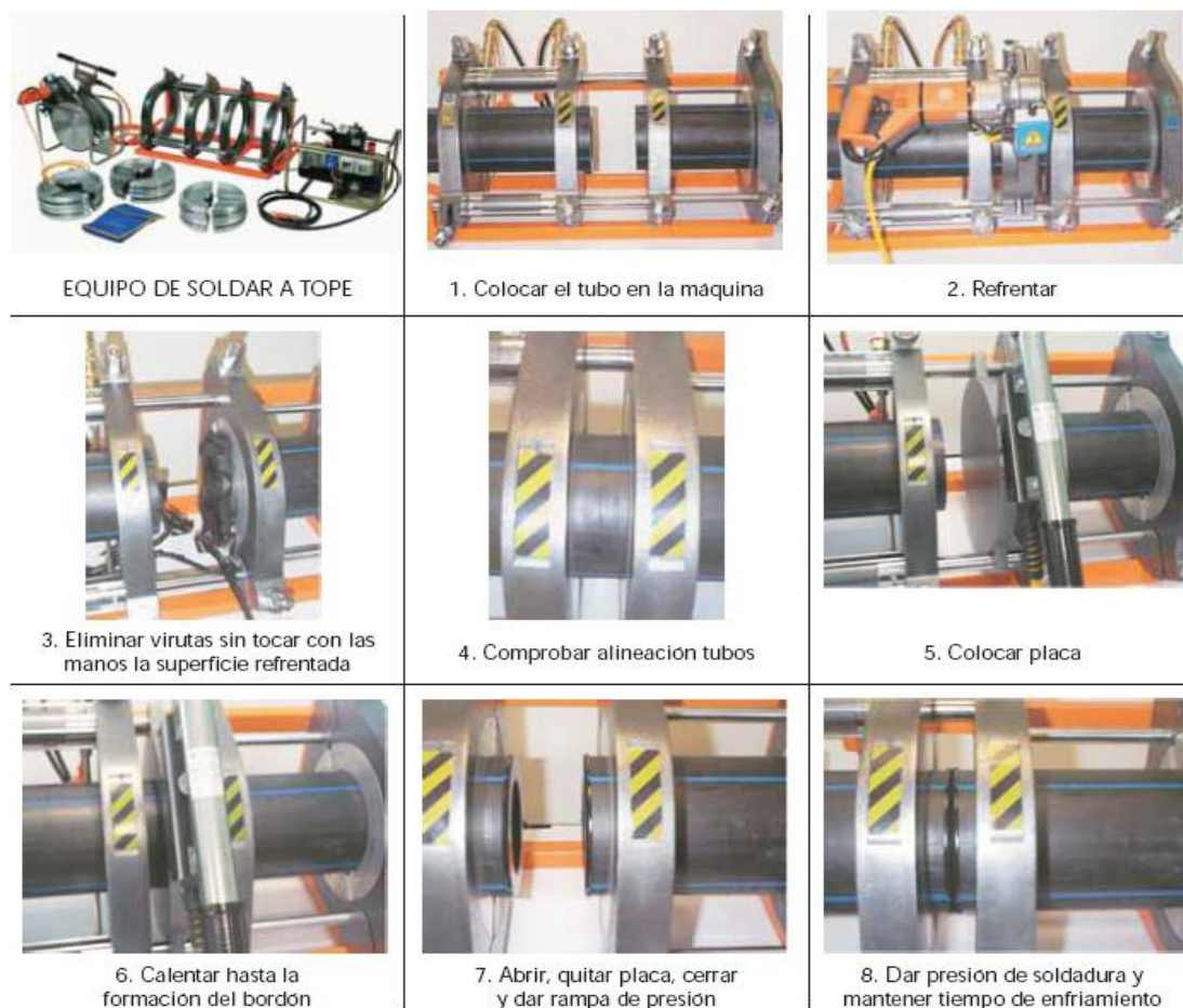
Figura 30. Resumen de proceso de soldadura a tope
