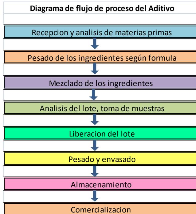
Figura 4.7 Diagrama flujo elaboración aditivo Fuente: C. Benavides, 2011
