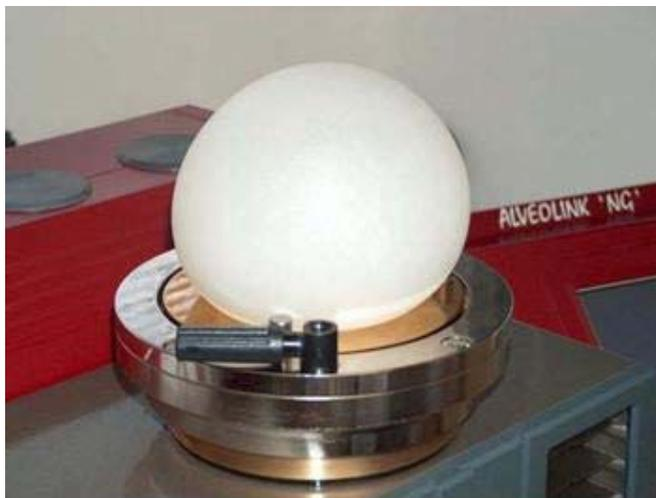
Figura 2.3 Burbuja de Alveógrafo
