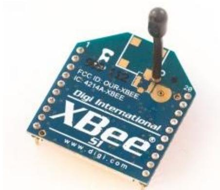
**Figura3.3: Módulo XBee S1**
