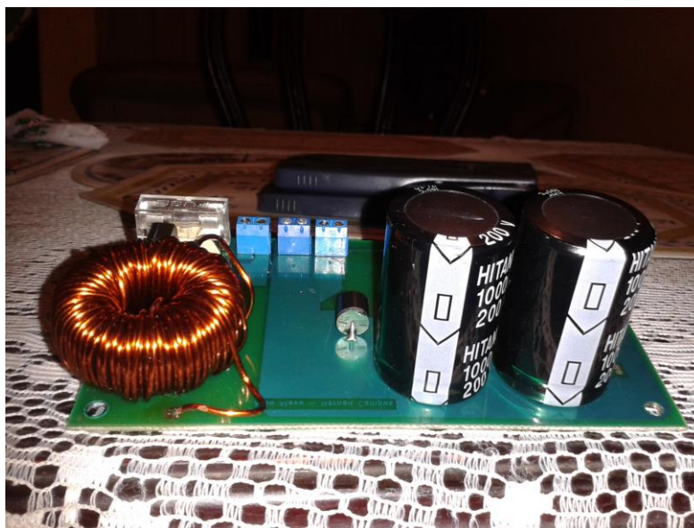
Figura 5.3. Parte superior de la placa electrónica del PFC.
