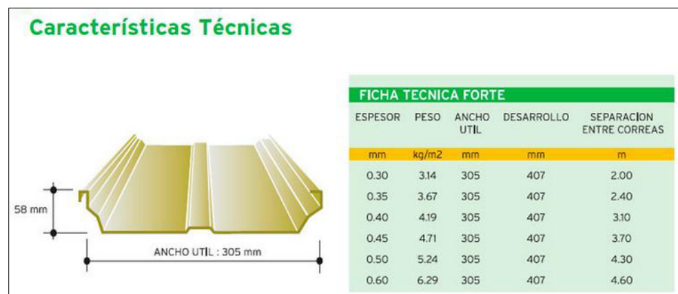
FIGURA 4.2 CARACTERÍSTICAS TÉCNICAS DE CUBIERTAS METÁLICAS (11)
