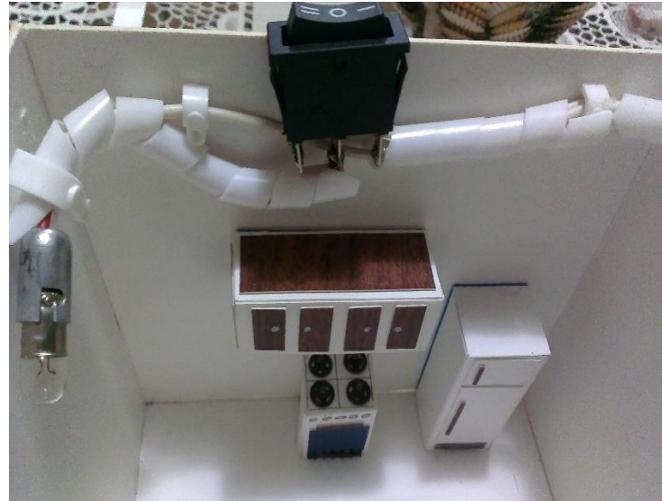
Figura E.2: Iluminación interna Switch y foco.
