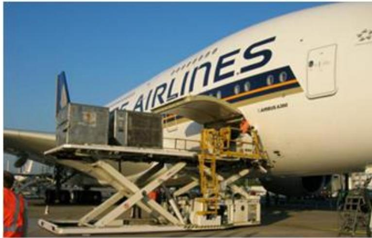
**FIGURA.55 OPERADOR INGRESANDO ULD A LA AERONAVE DESDE EL CARGO LOADER**
