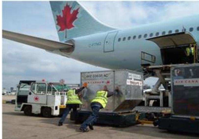
**FIGURA.92 ESFUERZO DE OPERADORES DE GRH PARA PASAR ULD DEL DOLLIE AL CARGO LOADER**
