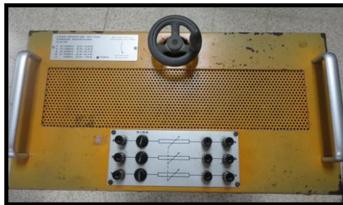
Figura 3. 4: Vista superior del banco resistivo MV1100
