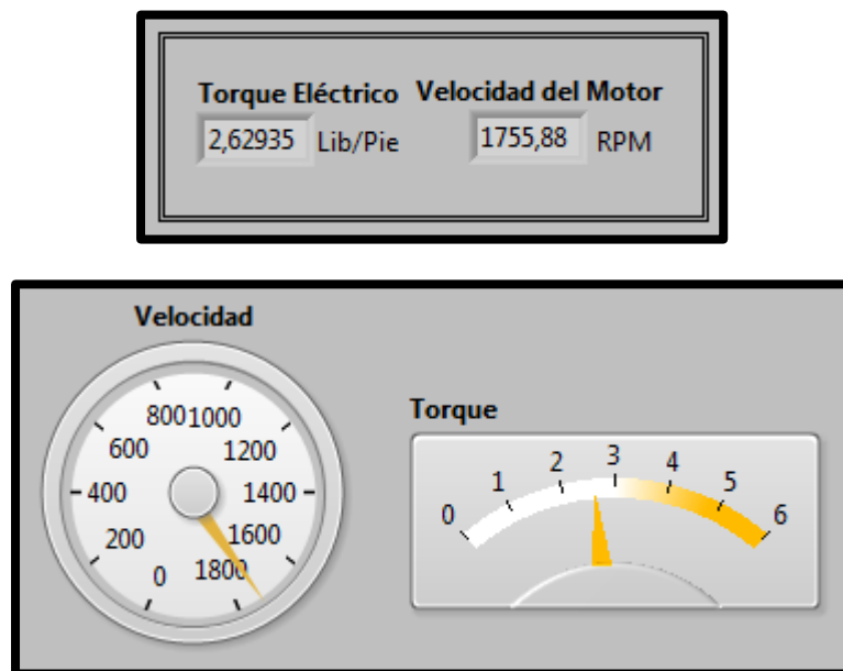
Figura 5. 4: valores del torque eléctrico y velocidad del motor ( variador sin carga).
