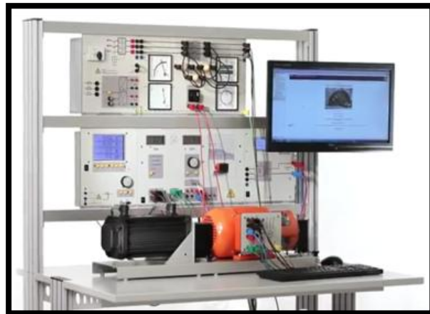
Figura 2. 4: Banco de Prueba para motores eléctricos con freno eléctrico.
