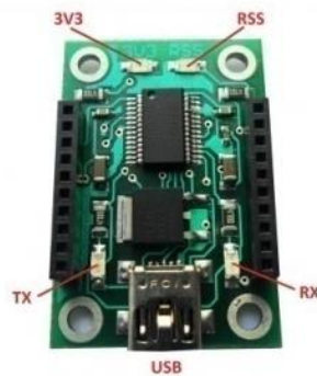
Figura 3.7 XBee Explorer USB (tomado de la página de ideas 'Ideas & Tecnologías')
