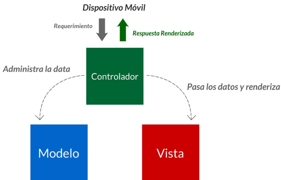
**Figura 3.2 - Esquema MVC utilizado en la aplicación**
