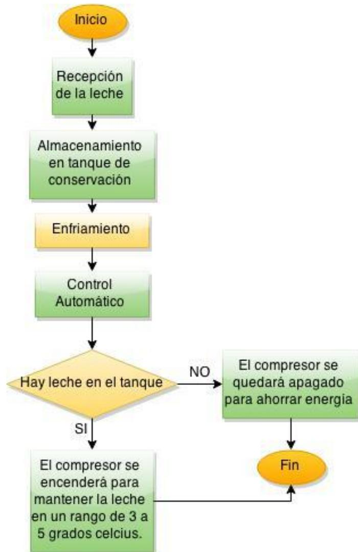
**Figura 3.6 – Diagrama de flujo del proceso de enfriamiento.**
