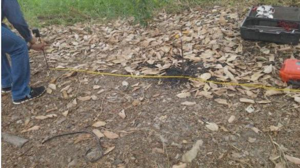
**Foto 03.** Colocación de picas para medición de resistividades aplicando el método Wenner.
