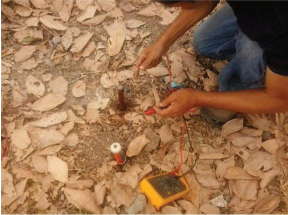
**Foto 07.** Colocación de los electrodos para realizar la medición.
