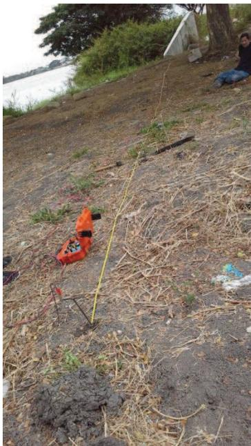
**Foto 05.** Instrumentos en posición para realizar la medición de resistividad.
