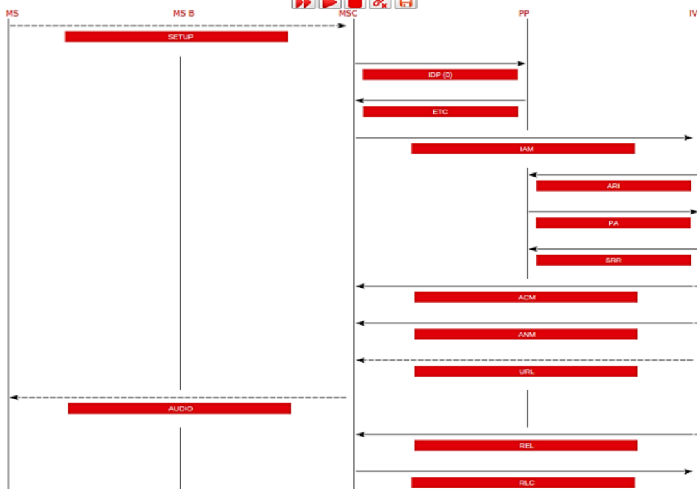
Figura 5. Interfaz de la señalización entre MSC y otros componentes de la red
