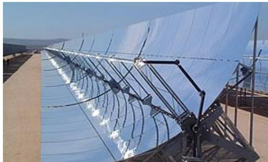
**Figura 2. 5** Concentrador cilindro-parabólico.
